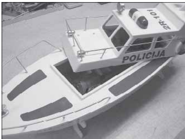
Okvir pod kabino preprečuje, da v model prodre voda, obenem pa drži kabino na svojem mestu, ki jo je tudi enostavno odstraniti.
